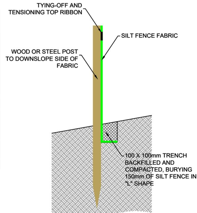
**TYPICAL SILT FENCE DETAIL**
